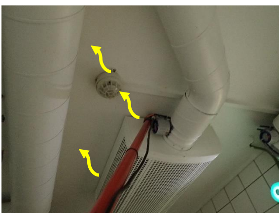
Kuva 240 Merkkiaineen vuotoa alakatossa olevien asennusten taustasta.
