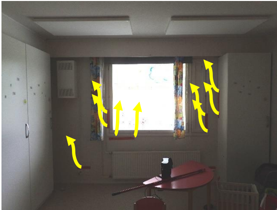
Kuva 100 MA 12 US. Merkkiaineen vuotoa ikkunaliittymistä, Kalusteasennuksen taustasta ja sähköasennusten kautta.
