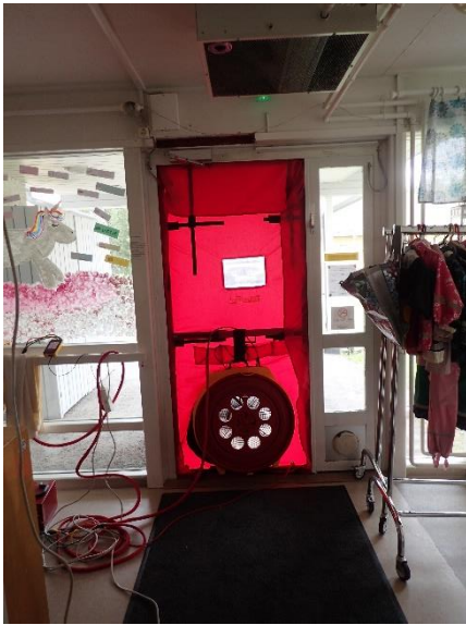
Kuva 232 Alipaineistusjärjestely. Keittiön ovet kii- lattiin auki tutkimuksen ajaksi.
