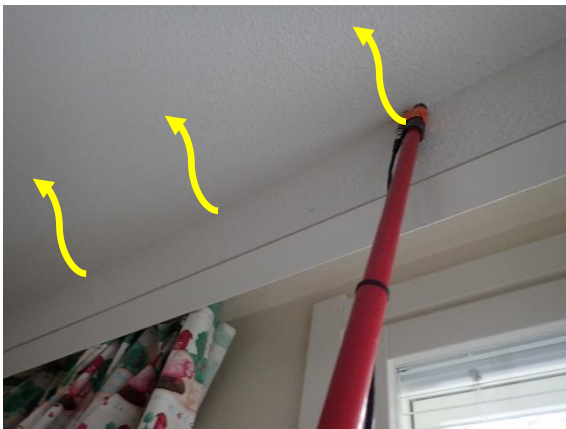
Kuva 96 MA 3 US. Merkkiaineen vuotoa seinän yläpohjaliittymästä verhokotelon sisältä.
