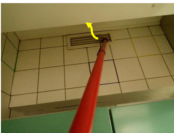
Kuva 244 Merkkiaineen vuotoa alakatosta huuvan kautta.
