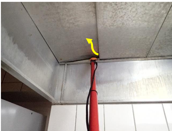
Kuva 244 Merkkiaineen vuotoa alakatosta huuvan kautta.
