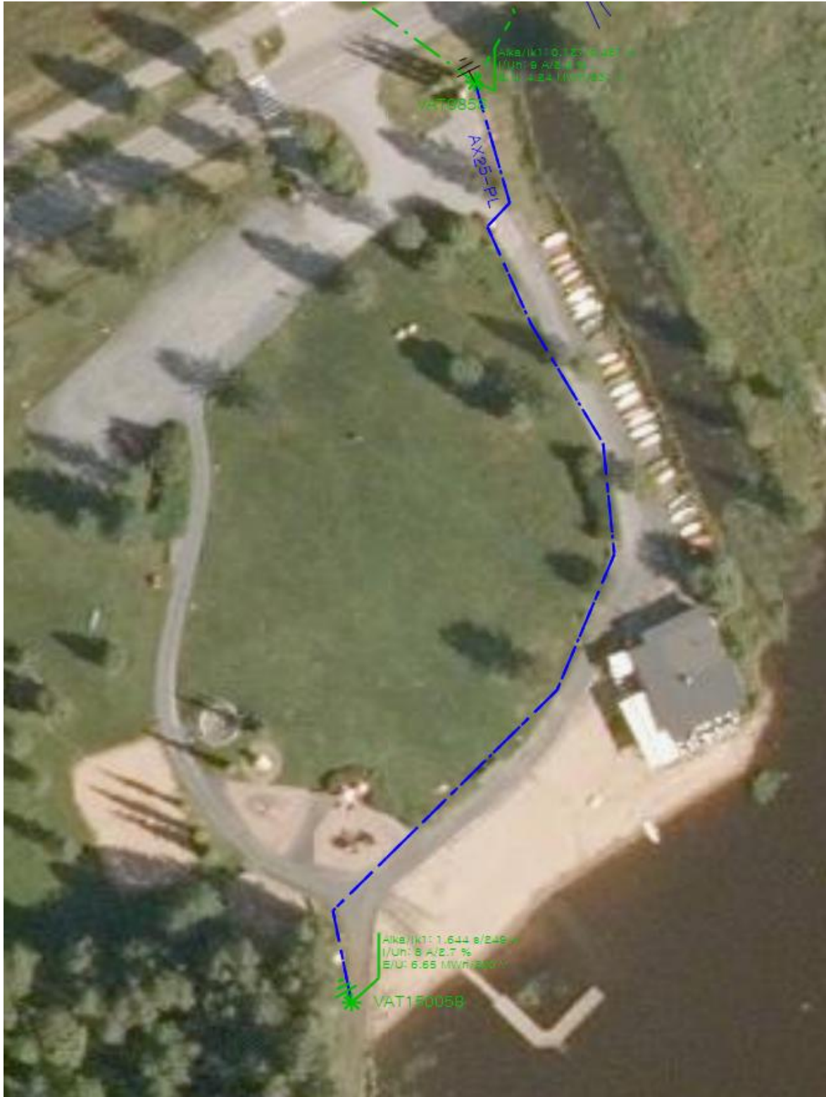
Kuva 3. Suunniteltu sähkökaapelin lisäys (sininen viiva).
